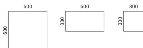
Akustische Wand- und Deckenplatten, H=48/68 mm
