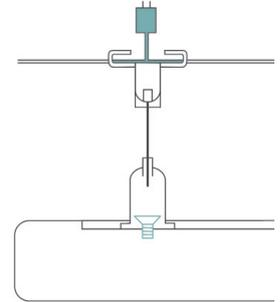
Nach der Montage eines Akustikpanels entsteht ein Abstand von 10 mm zwischen dem Paneel und der Wand.
